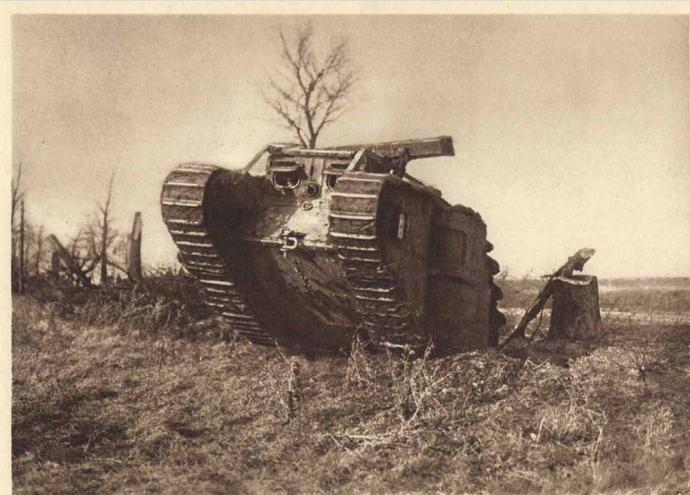
Englischer Tank. Deutlich sind die 1/2 m breiten ungeschützten Laufbänder zu sehen, mit deren Hilfe sich das Ungeheuer fortbewegt. Die Engländer unterschieden zwei Arten von Tanks, männliche mit zwei Geschützen und zwei Maschinengewehren und weibliche, die nur mit fünf Maschinengewehren besetzt sind. Die Panzerung ist 8-14 mm stark, die Geschwindigkeit beträgt 6 km/Std.
