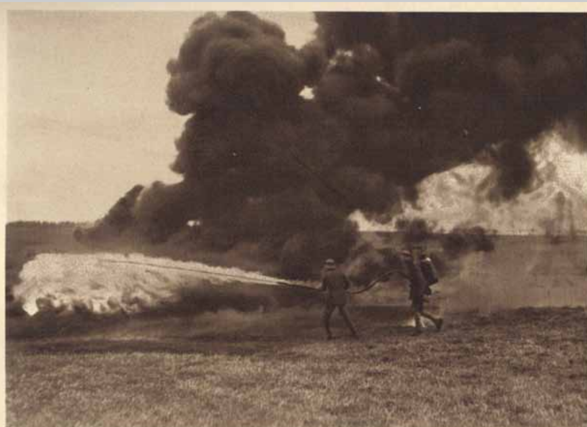
In den modernsten Kampfmitteln gehörte der „Flammenwerfer“, der insbesondere gegen Unterstände, Maschinengewehrstellungen und Tanks Verwendung fand. Es handelt sich um einen tragbaren zylinderförmigen Behälter mit langem Schläuchchen, aus dem mittels Druckluft brennendes Öl in einer riesigen Stichflamme geschießt wurde. Die Entzündung erfolgte beim Auslösen auf demselben Wege. Die dabei entwickelte Hitze war so stark, daß die getroffenen sofort in Kohle verbrannten. Hinter der starken Rauchwolke konnten sich die Sturmtruppen leicht entwickeln.
